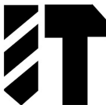
Symbol VRTANIE / KLADIVO: vibračné vrtanie do betónu a kameňa
