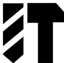
ознака БУРГИЈА/ЧЕКАН: вибрациско бушење во бетон и камен
